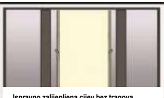
Ispravno zalijepljena cijev bez tragova oštećenja silikona
